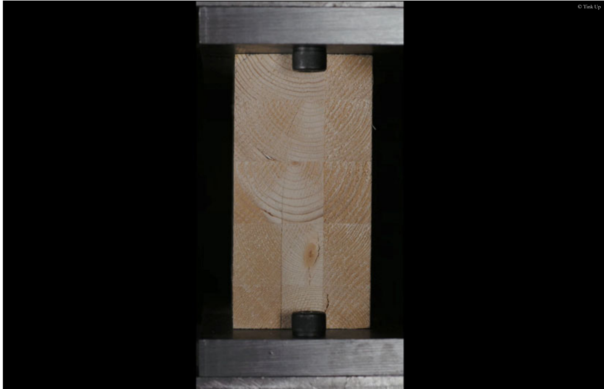
Brettschichtholz (Glulam) - Druckprüfung
