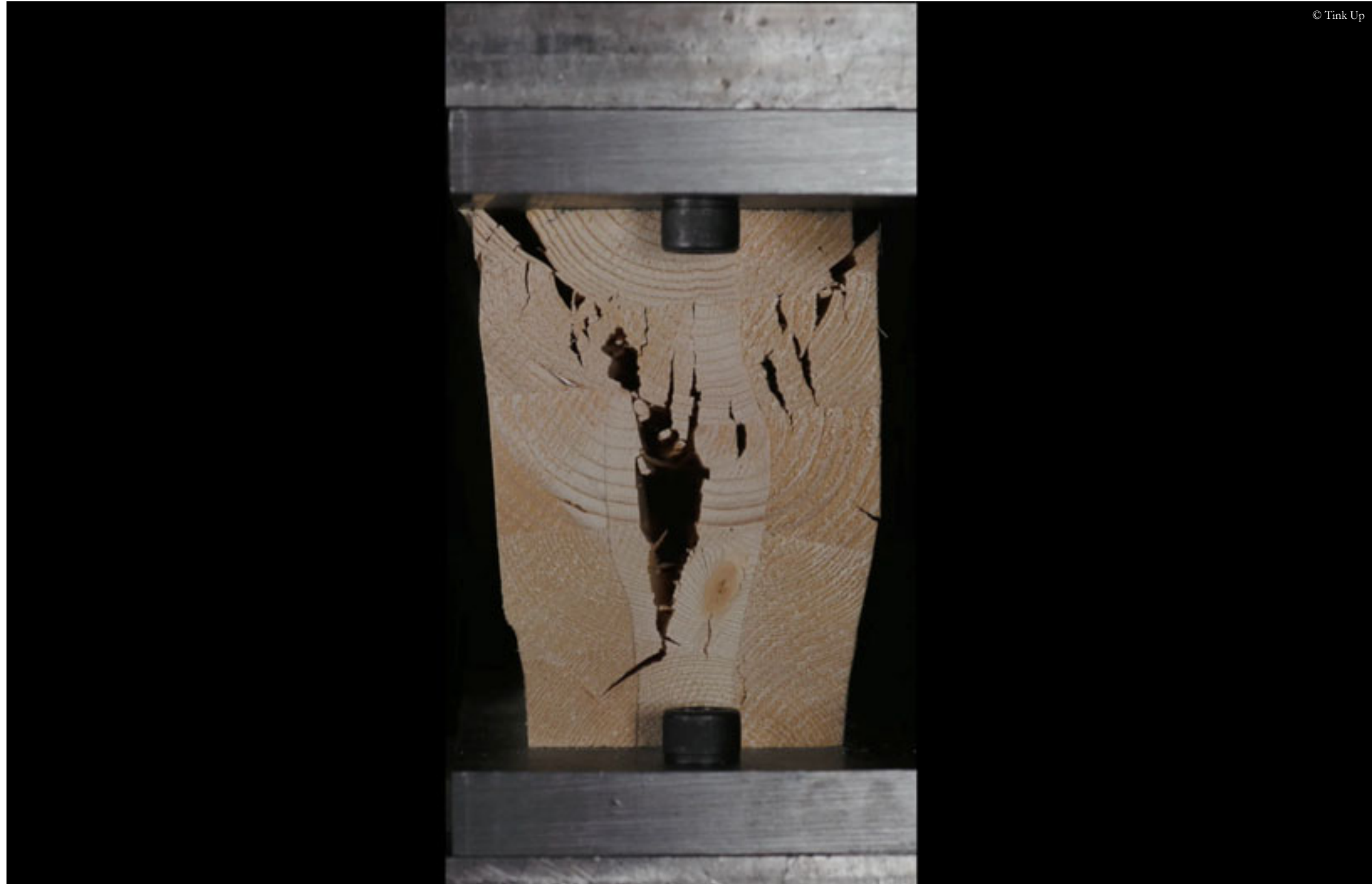
Brettschichtholz (Glulam) - Druckprüfung
