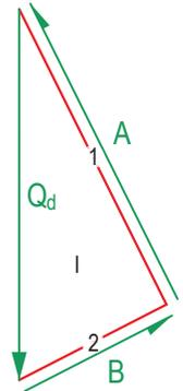
Um den Seildurchmesser zu berechnen, wird die massgebende Kraft  $N_{dmax}$  im Tragwerk ermittelt. Als massgebende Kraft versteht sich die grösste innere Kraft. In diesem Fall ist dies Element 1 mit einer Länge von 4 m, und daher einer Grösse von 40 kN.
