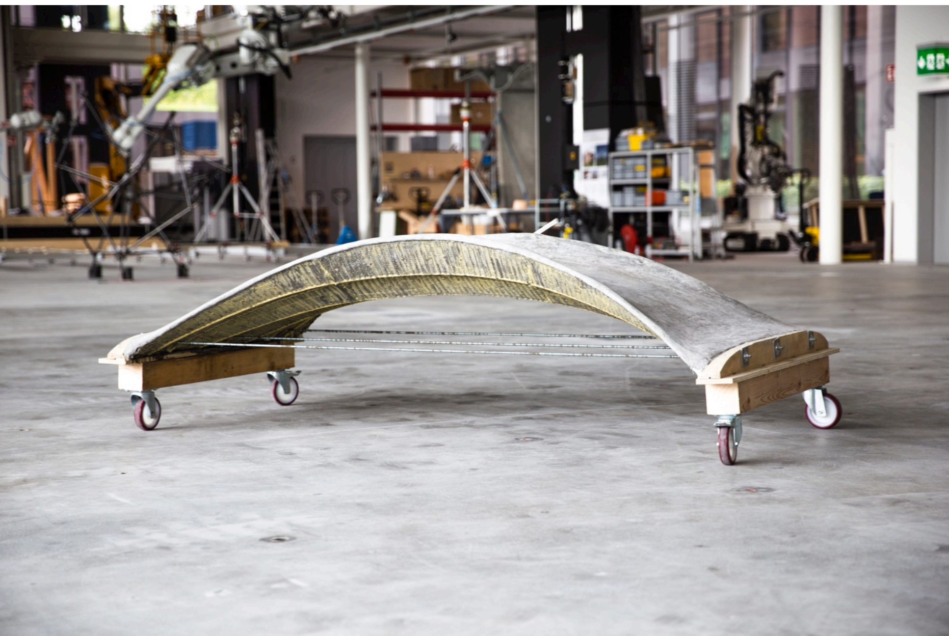
Schalung aus Stoff: Block forscht derzeit an komplexen Geweben, die eine Maschine strickt und die mit Beton bestrichen aushärten. Foto: ETH Zürich, Block Research Group
