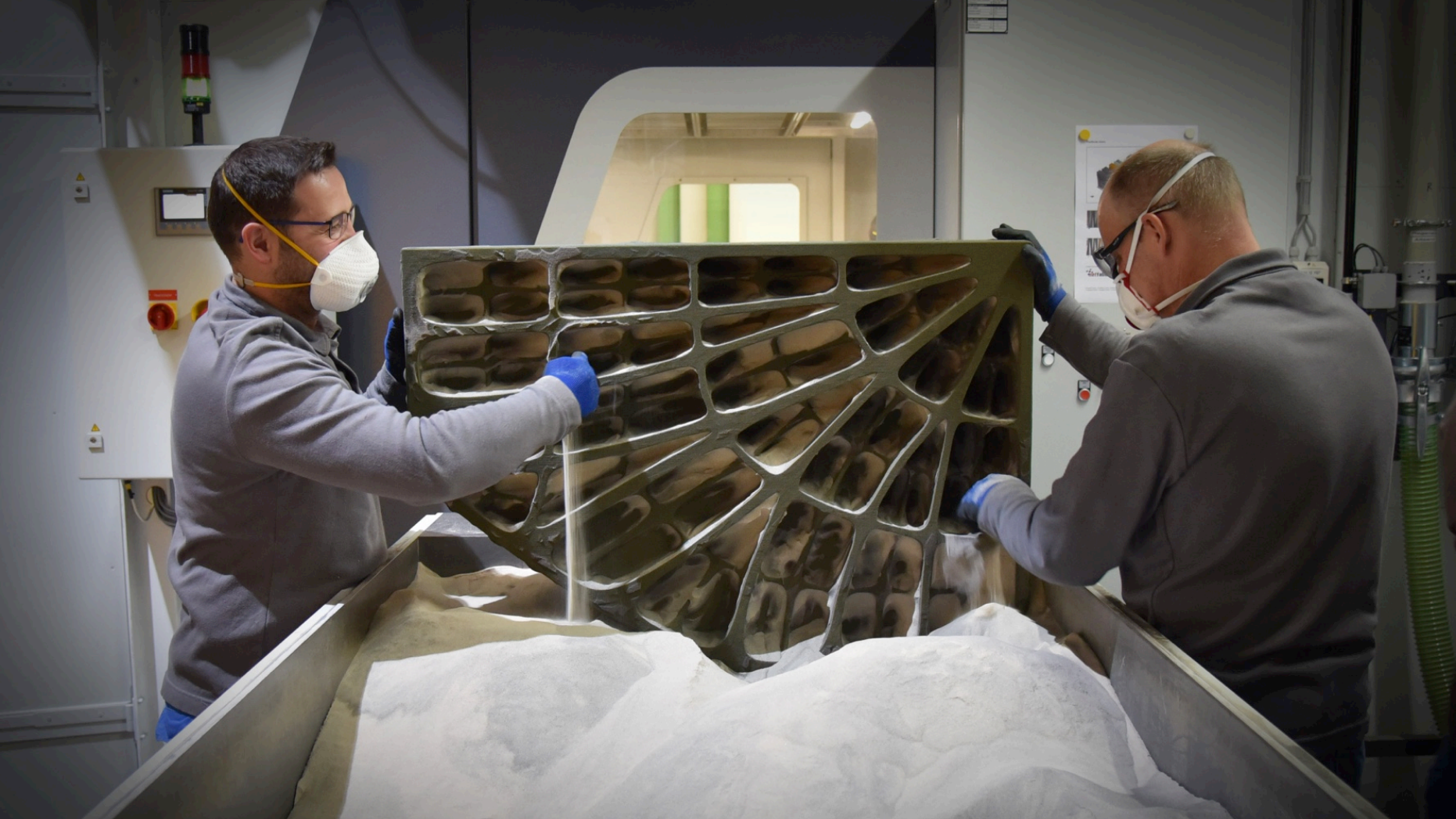
Schalen für alle: Philippe Block's Team entwickelte Deckenelemente, deren Traggerippe 3-D-gedruckt und zwei Zentimeter dick ausbetoniert wird. Foto: ETH Zürich, Block Research Group
