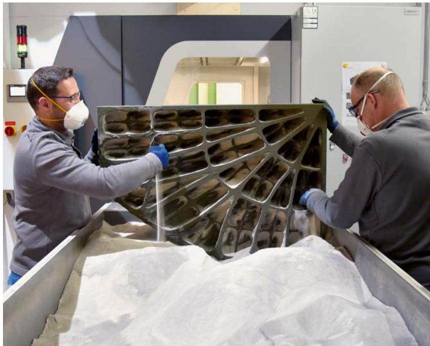
Neuartige Herstellungsmethoden für die Betonrippendecken des HiLo, wie etwa 3-D-gedruckte Schalungselemente, werden derzeit untersucht.
